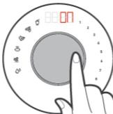
2. ON/OFF & 작동 버튼을 누르고 있으면 모터가 가장 빠른 스피드로 작동하며 작동 표시 LED는 ON으로 표시가 바뀝니다.
